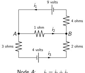
Node A:  $i_1 = i_2 + i_3$ Node B:  $i_2 + i_3 = i_1$
